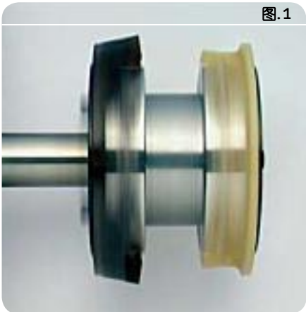
图1 SKF标准轴承和E2轴承的聚酰胺保持架的转速为8000转/分钟。右图所示E2轴承保持架的变形明显小得多。
